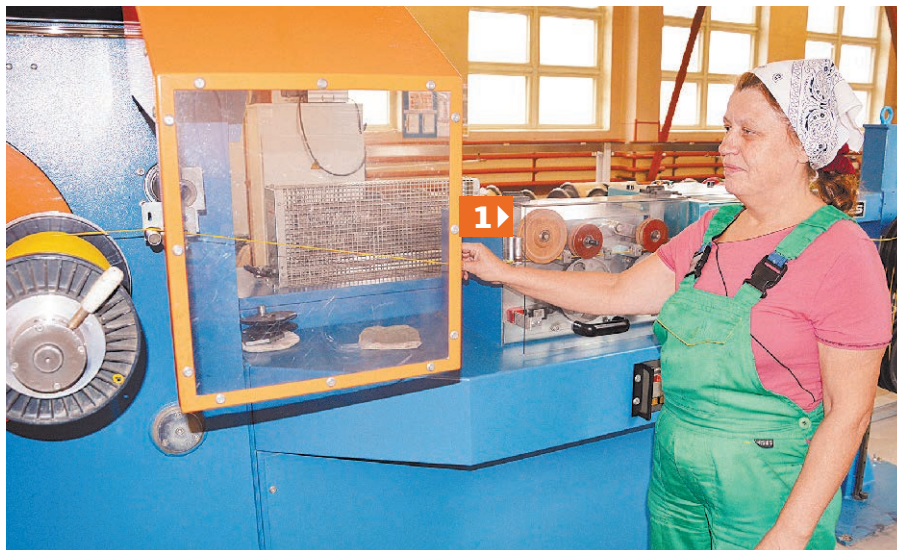
При перематке проводов испытатель проверяет целостность их оболочки
