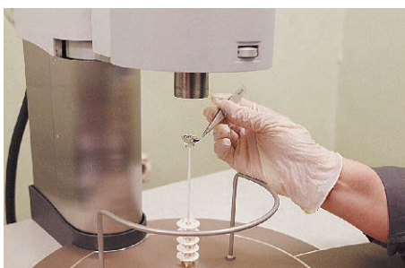
Перед проведением анализа образец материала помещается в держатель
