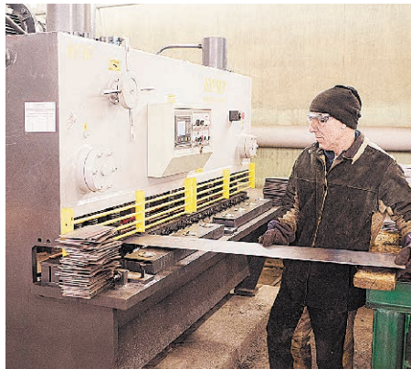
Ножи из закаленной стали легко рубят металл толщиной до 6 мм
