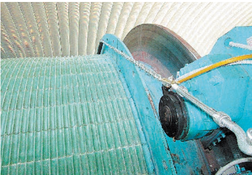
Барабан вращается, а стержень протачивает канавки футеровки до необходимых размеров
