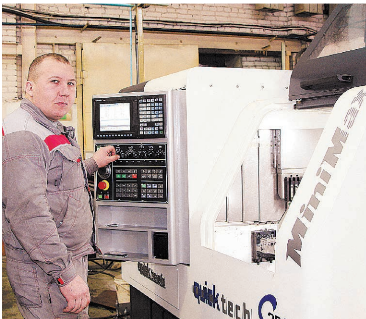
Оператор-наладчик Александр Завьялов: «Автоматы продольного точения могут обрабатывать как мелкие детали, так и очень длинные»
